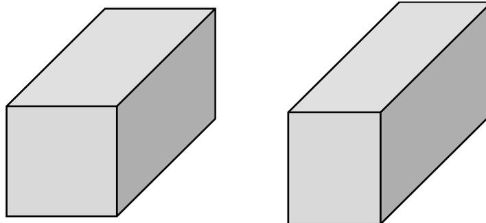
Les briques Interblocs sont disponibles dans deux finitions : **rustique** aux arêtes écornées et épauffrées après passage dans un tambour métallique tournant **ou franc** aux arêtes vives.
