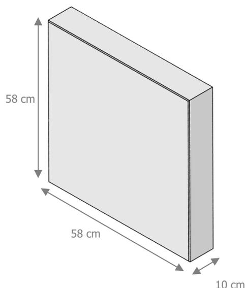
Les bordures béton d'Interblocs sont lisses (chanfrein limité à 2/2 mm). D'autres finitions sont envisageables.
